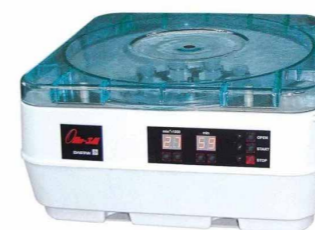
Центрифуга лаб. мед. ОПн-3.01 Переносная, периодического действия. Предназначена для применения в практике лабораторной клинической диагностики. Обеспечивает разделение на фракции неоднородных жидких систем плотностью до 2 г/см.куб. под воздействием центробежных сил.
