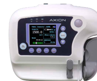
Дозатор шприцевый Д01 Применяется в условиях автомобилей скорой медицинской помощи и стационаров для введения лекарственных средств с постоянной низкой скоростью в течение продолжительного времени.
