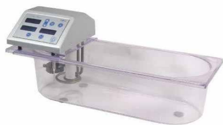
Термостат медицинский TW-2 (термобаня водяная объемом 4,5л) с другим термостатом С микропроцессорной системой управления, обеспечивающей следующие параметры: задание, поддержание и отображение температуры на световых индикаторах; два независимых секундомера; датчик уровня воды в ванне; подсветка ванны.
